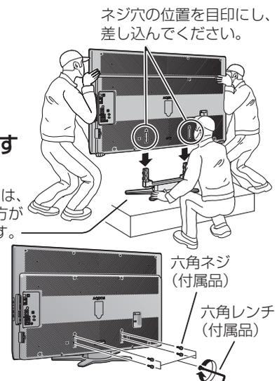
六角ネジは、六角レンチで確実に締め付けて固定してください。スタンドを固定したら、ネジが確実に締まっていて、スタンドのぐらつきや緩みがないことをご確認ください。
