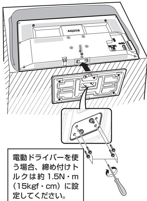
電動ドライバーを使う場合、締め付けトルクは約 1.5N・m (15kgf・cm) に設定してください。
