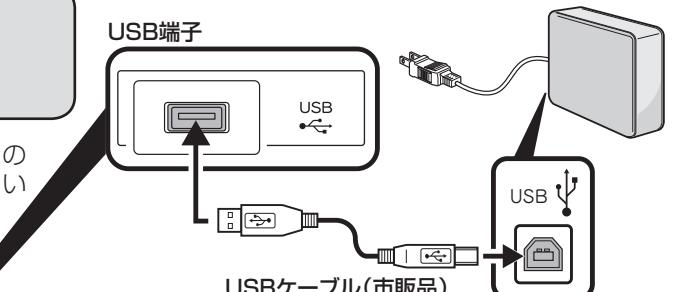
USBケーブルを抜き差しする場合は、必ず電源が切れた状態で行ってください。
