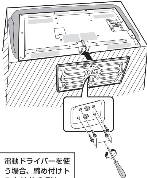
電動ドライバーを使う場合、締め付けトルクは約  $1.5\text{N}\cdot\text{m}$  ( $15\text{kgf}\cdot\text{cm}$ ) に設定してください。
