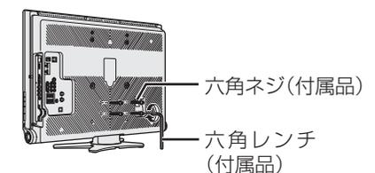
スタンド固定用の六角ネジは、六角レンチで確実に締め付け、固定してください。
