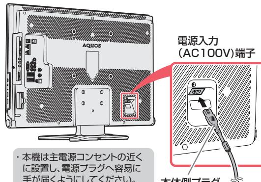
・本機は主電源コンセントの近くに設置し、電源プラグへ容易に手が届くようにしてください。
