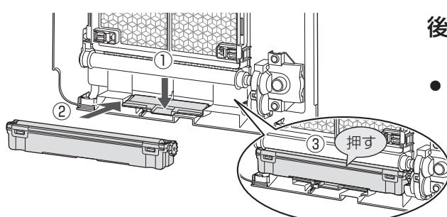
後ろパネルにダストボックスを取り付ける
