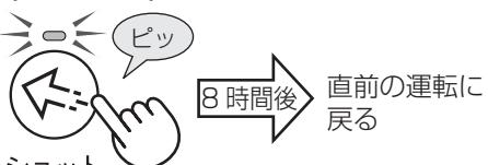
● 後ろルーバーを閉じ、前ルーバーをスイングさせて約 8 時間強めの風量で運転し、前方向にプラズマクラスターイオンを集中的に放出します。
