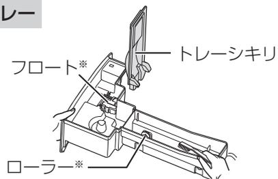
※ フロート・ローラーは取りはずさない (水漏れ・故障の原因) はずれた場合 44 ページ
