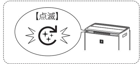
前回のお掃除からの運転時間が約 48 時間経過するたびに、現在の運転を中断して、自動的にプレフィルターのお掃除を始めます。(自動掃除時間は約 7 分間)
