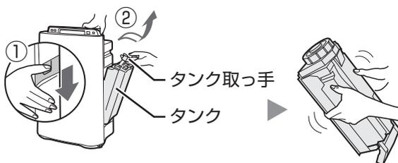
タンクを取り出し、タンクに少量の水を入れて、振り洗いをする
