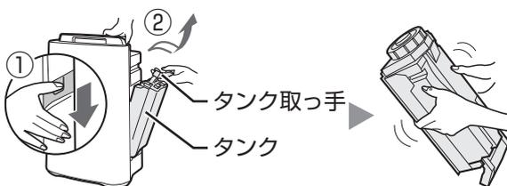
タンクを取り出し、タンクに少量の水を入れて、振り洗いをする
