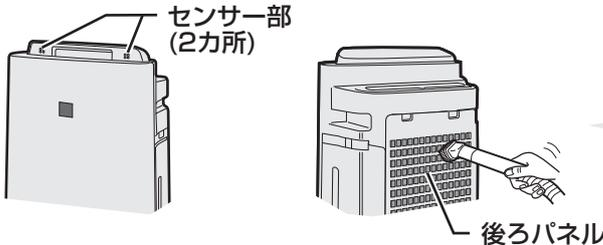
センサー部・後ろパネルのホコリを掃除機で吸い取る
