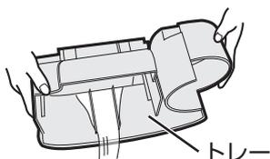
トレーの水を排水し、各部のお手入れをして、各部品を元通り取り付け
