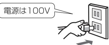
水平で丈夫な場所に設置し、差込プラグをコンセントに差し込む
