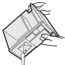
運転を停止し、排水タンクの水を抜く
