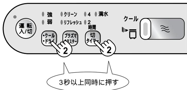
元に戻したい場合は、② の操作をもう一度おこなうか、差込プラグをコンセントから抜き、再度差し込むと設定が解除されます。
