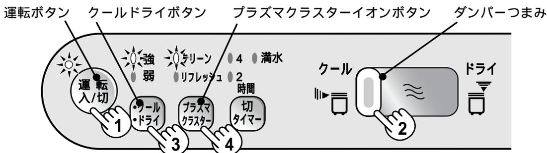
**1** 運転ボタンを押す。運転ランプが点灯し、前回の運転モードの運転が始まります。
