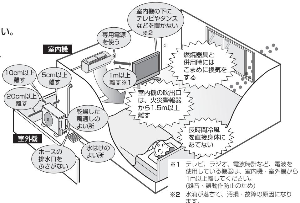
\*1 テレビ、ラジオ、電波時計など、電波を使用している機器は、室内機・室外機から1m以上離してください。
