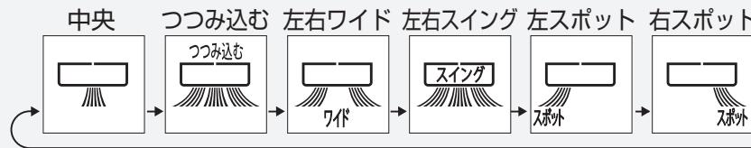
●冷房時、冷風感を求めたい場合は、「中央」「左スポット」「右スポット」などで、人のいる方向に風向を設定してください。
