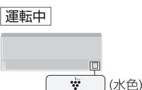
停止中にカビが増殖しやすい条件になると、ルーバーを閉じたままエアコン内部の空気を循環させます。ファンを通常とは逆に回転させて、プラズマクラスターイオンを効率よく発生させることで、エアコン内部へのカビの増殖を抑制します。
