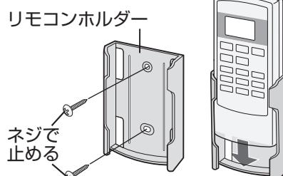
(※ネジの頭がホルダー表面より突き出ないように、しっかりと締め付けてください。)
