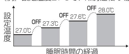
室温の上がりすぎ、下がりすぎを防ぐため、設定温度を徐々に変化させ、快適な目覚めをサポートします。また、周期的に運転をOFFさせてムダな電気代を抑えます。
