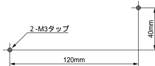
⊕ドライバーで固定ビス2本を締め付けて、本ユニットを固定します。
