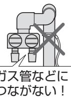
ガス管や水道管、電話や避雷針のアース線には絶対に接続しないでください。(法令で禁止されています)
