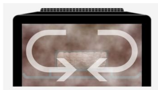
庫内の水蒸気をファンで循環させ 食品に効果的に熱を与える
