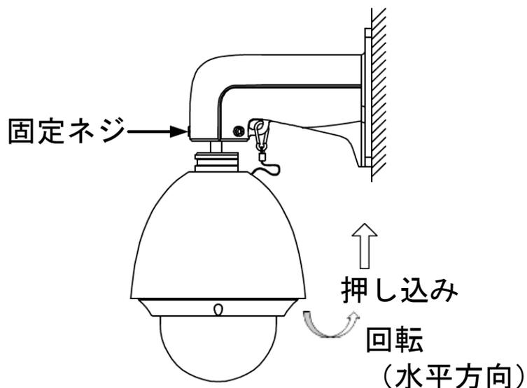
8. 壁面取付金具の固定ネジをレンチで締めて PTZ カメラを固定し、PTZ カメラの保護フィルムを剥がします。
