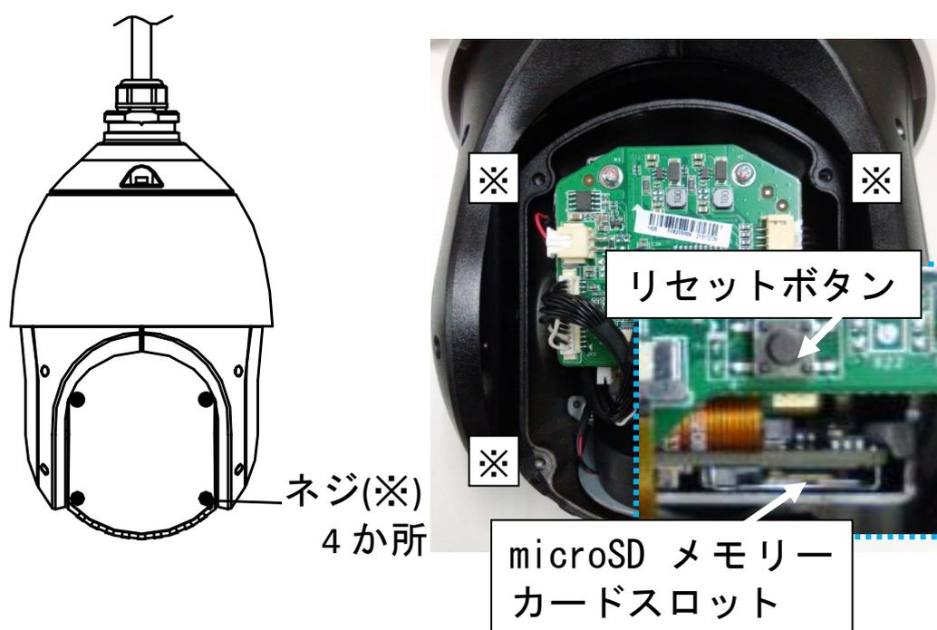
2. microSD メモリーカードを microSD メモリーカードスロットへ挿入します。
