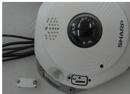
6. microSD メモリーカードスロットに microSD メモリーカードを挿入し、押し込んで固定します。
