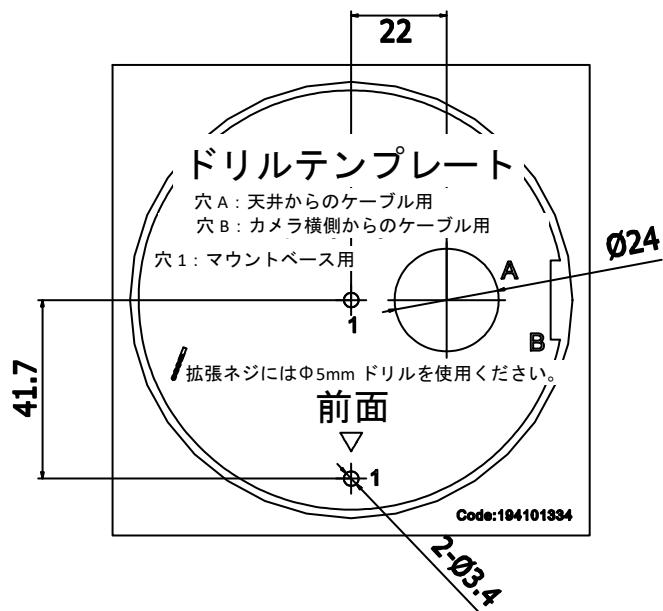
2. ネジ穴とケーブル穴にベースプレートを合わせて、同梱の 2 本のネジで天井に固定します。
