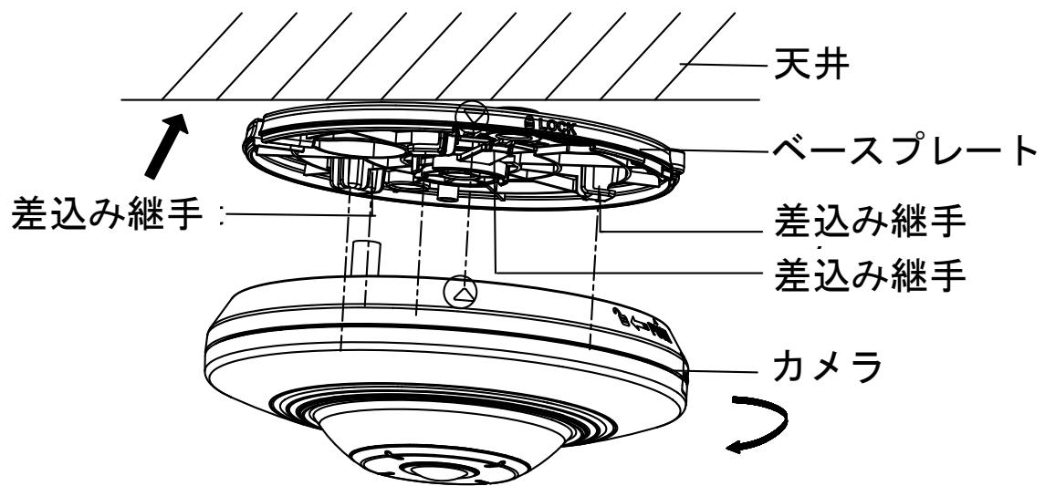
5. ベースプレートのプッシュ (PUSH) ボタンを押しながらカメラを反時計回りに回すと、カメラをベースプレートから取り外せます。
