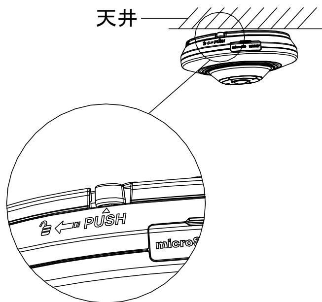
6. ベースプレートと一緒にカメラ本体を時計回りまたは反時計回りに回し、ビュー角度を調整します。
