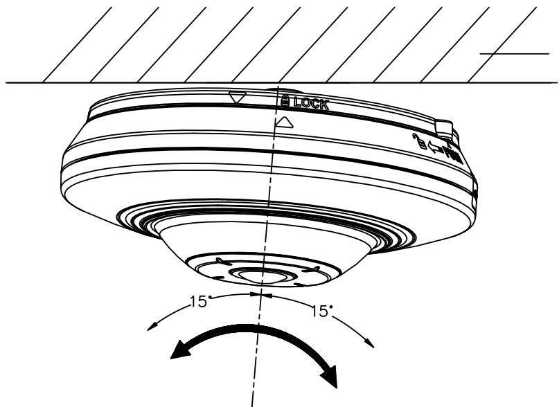
時計/反時計回りに調整
