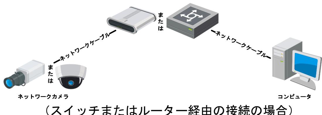
**注意：**本製品は法令上、電気通信事業者（移動通信会社、固定通信会社、インターネットプロバイダなど）の通信回線（公衆無線 LAN を含む）に直接接続することはできません。本製品をインターネットに接続する場合は、必ずルーターなどの機器を経由して接続してください。
