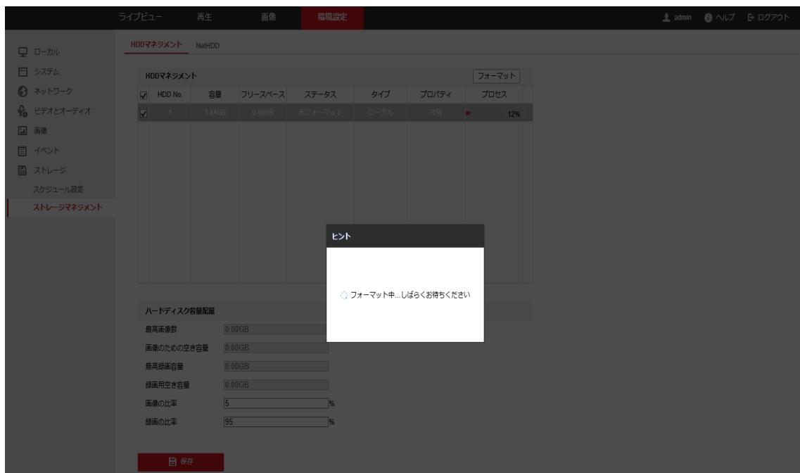
5. しばらくすると、ステータスが「通常」に変化します。その後、カメラで、動体検知などのイベントトリガービデオの microSD メモリーカードへの録画が開始できます。
