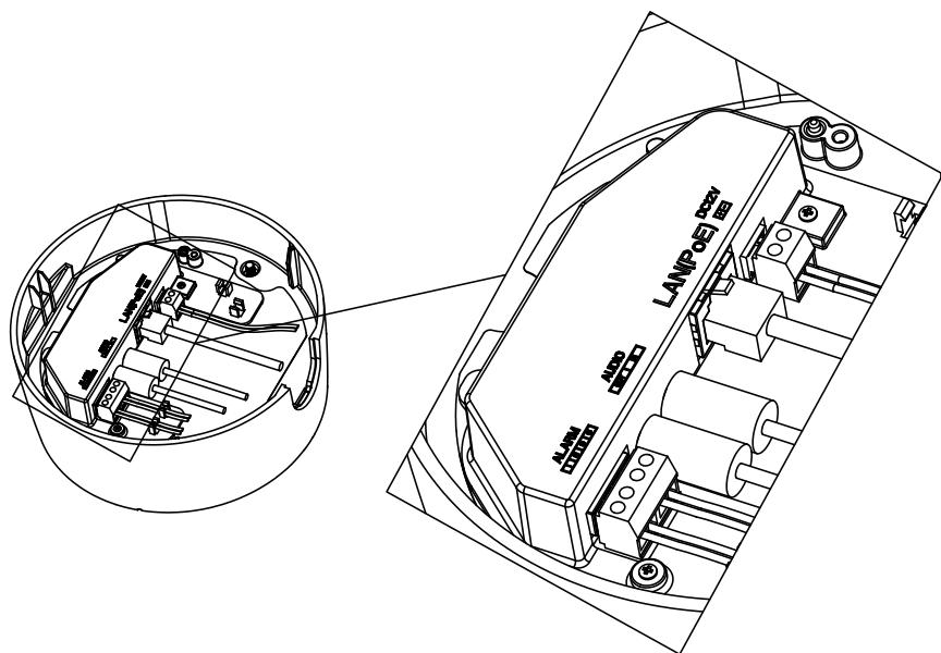
8. カメラ本体をネジ 3 本でジャンクションボックスに固定します。
