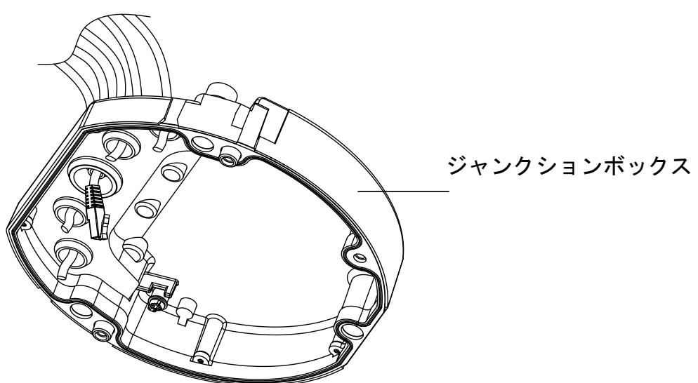
5. ジャンクションボックスとベースプレートの「前面」マークの向きを合わせてください。ジャンクションボックスをベースプレートにネジ 3 本で固定します。
