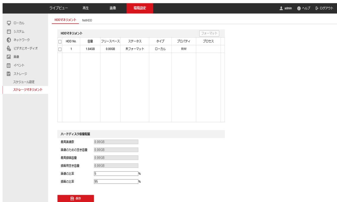
2. microSD メモリーカードの状態が「未フォーマット」と表示されている場合、対象の microSD メモリーカードのチェックボックスにチェックを入れ、フォーマットのボタンを押します。
