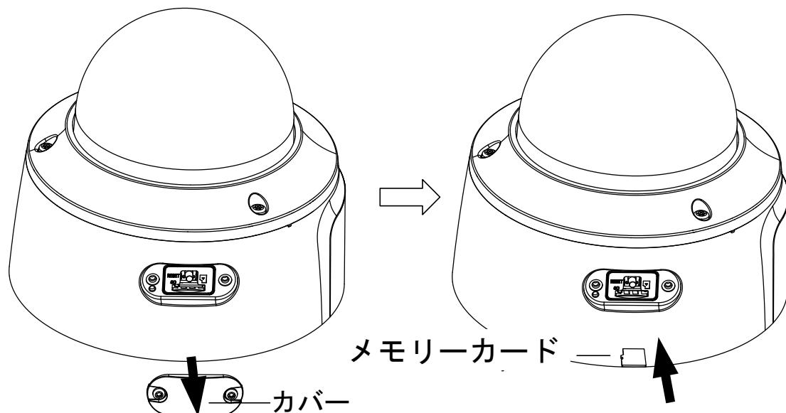
2. microSD メモリーカードを microSD メモリーカードスロットへ挿入します。
