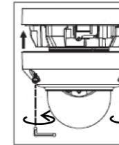
フロントカバーを取り付け、六角ネジ（3カ所）を固定します。
