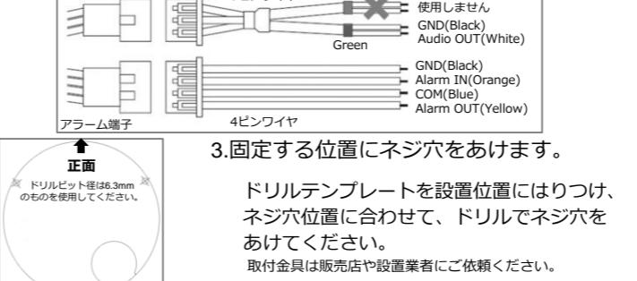
ドリルテンプレートを設置位置にはりつけ、ネジ穴位置に合わせて、ドリルでネジ穴をあけてください。
