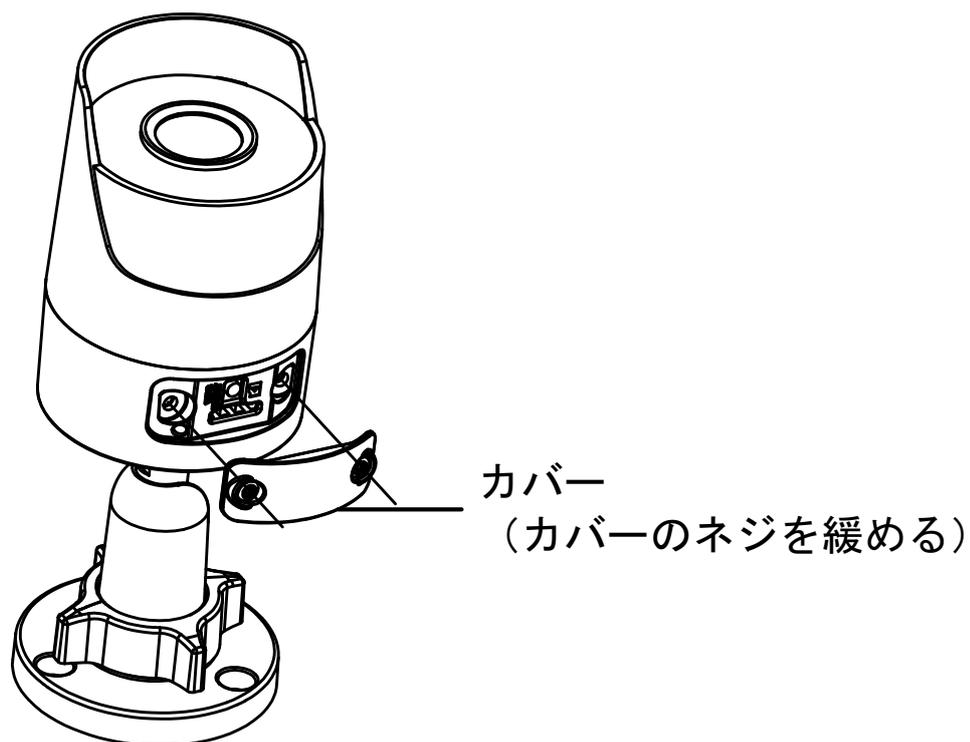
2. microSD メモリーカードスロットに microSD メモリーカードを挿入します。
