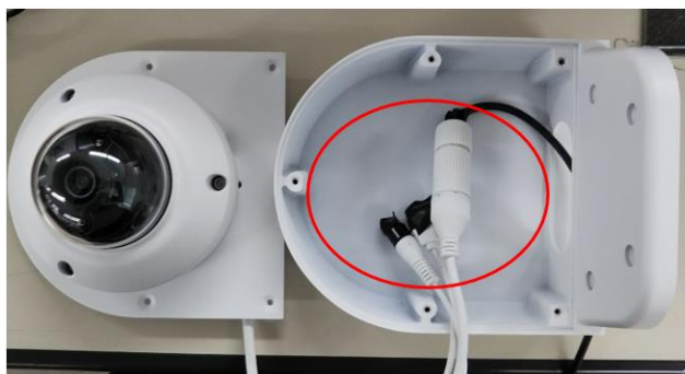
カメラのケーブルを本器具内に収める
