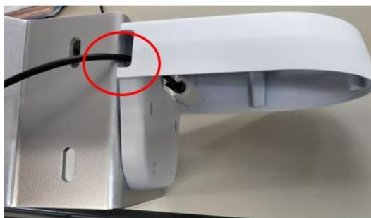
4. カメラのコネクタとイーサネットケーブルを接続し、ケーブルを取付金具 YC-MW01 の内部に収めます。
