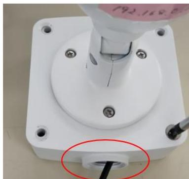
取付金具 YC-MJ01 部品のキャップを配線口（底面）に取り付けます。キャップは緩む事の無いようにマイナスドライバー（刃厚 2mm 以下）でしっかりと締め付けてください。
