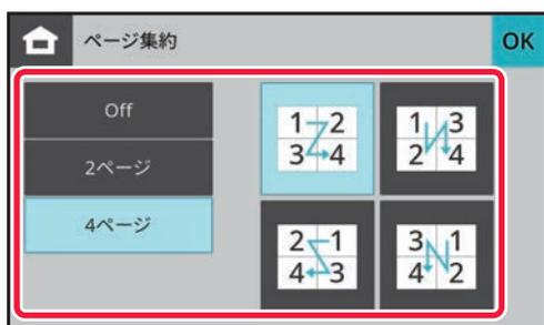
集約したい原稿の枚数と、レイアウトが表示されているキーをタップする
