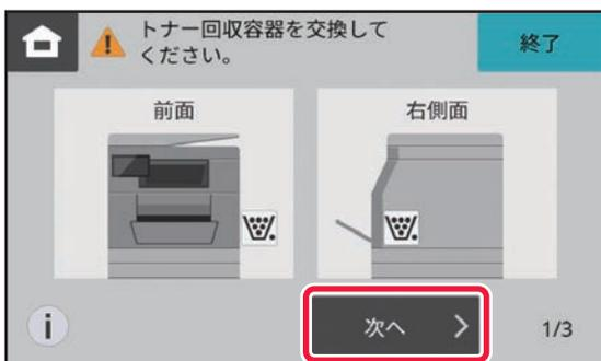
このようなときは、タッチパネルに表示されているトナー回収容器の交換方法を見るための[次へ]キーをタップしてください。
