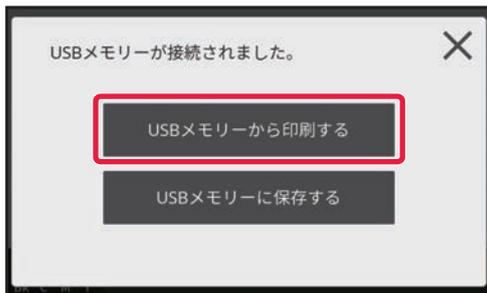
操作を選択する画面が表示されたら、**[USBメモリーから印刷する]**をタップする
