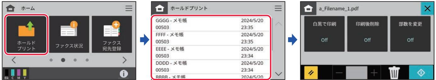
印刷したいデータをタップすると、印刷設定画面が表示されます。
