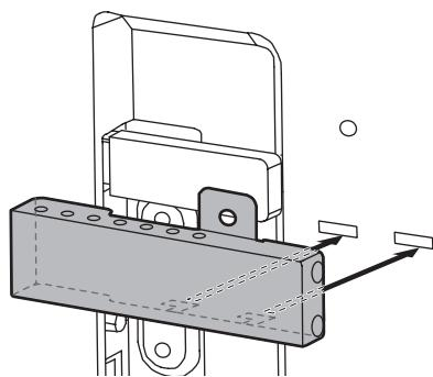
3. USBメモリーカバーを左側にずらし、付属のネジで固定する。
