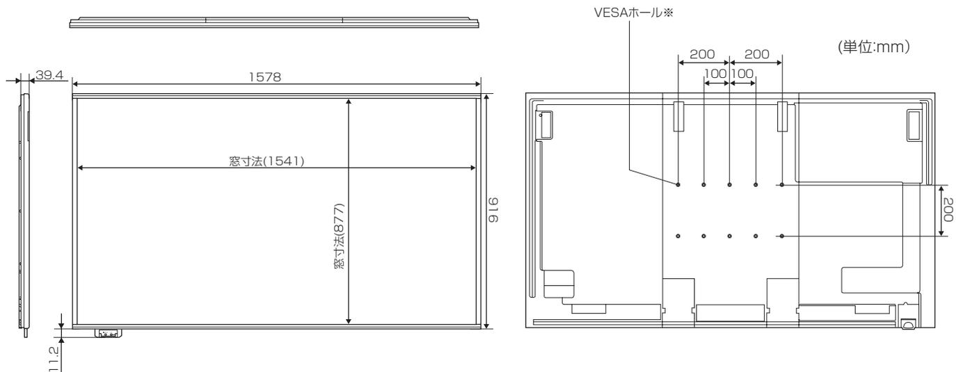
※ VESA 規格の金具の取り付けには、M6 ネジで、長さが取り付け金具の厚さ +8 ~ 10mm のものを使用してください。
