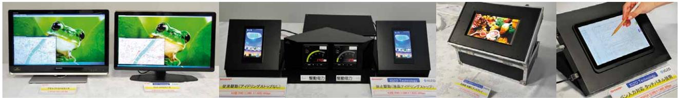
晶状態のInGaZnOを採用している。InGaZnOを結晶化したことで、一段と特性が安定する。これによって、優れたチャネル特性や低リーク電流などIGZOがもたらす優れた特性を一段と高いレベルで引き出すことができる。
