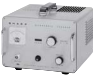
可清洗大型时钟的超声波清洗机
