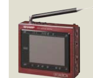
TFT式3英寸液晶彩色电视机“Crystaltron”
