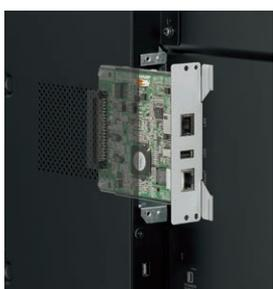
背面の拡張スロットに差し込んで使用(写真はPN-ZB03H取り付けイメージ)
