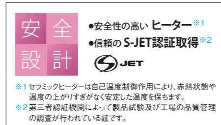
\*1 セラミックヒーターは自己温度制御作用により、赤熱状態や温度の上がりすぎがなく安定した温度を保ちます。
