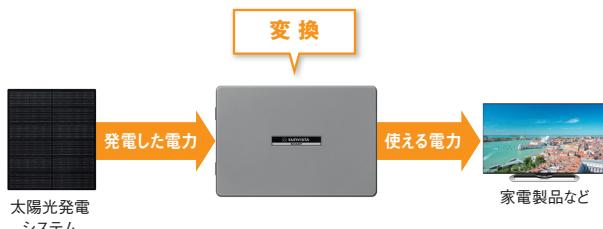
太陽光発電でつくった直流電力をパワーコンディショナで家庭内で使える交流電力に変換します。
