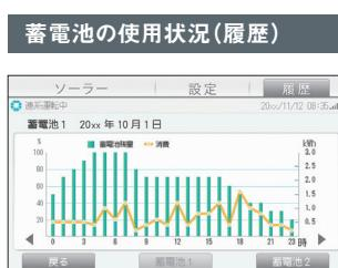
蓄電池の使用状況を履歴で表示。使用傾向が分かるから、計画的に使えます。
