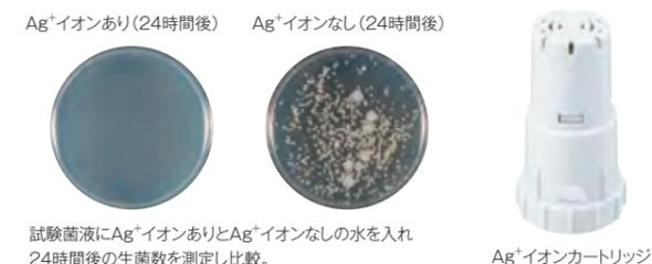
試験菌液にAg<sup>+</sup>イオンありとAg<sup>+</sup>イオンなしの水を入れ、24時間後の生菌数を測定し比較。 Ag<sup>+</sup>イオンカートリッジ
