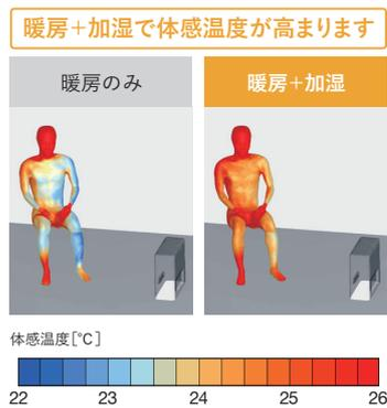
商品の吹出口前方直線方向に上からサーモビューカメラで温風温度を測定。室温(25°C)から10°C高い地点(サーモビュー上で35°Cの地点)で、HX-RK12[2022年]210cm、HX-L120[2020年従来機種]102cmを比較。
