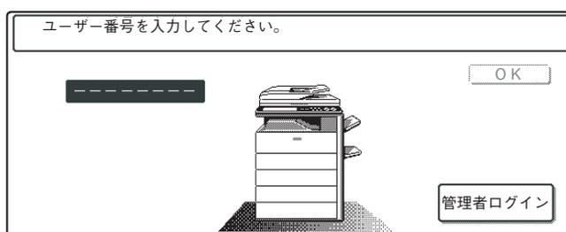
この方式では、本機のシステム設定で登録しているユーザー番号（5～8桁）を数字キーで入力してログインします。
