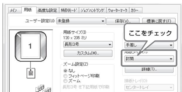
プリンタドライバの設定で、用紙タイプを[封筒]に設定してください。
