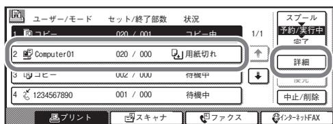
操作パネルの[ジョブ状況]キーを押し、ジョブ状況画面を表示させてください。
