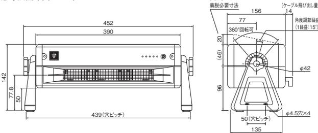
■ネジ留め図 本体を設置する場所にφ4~φ5の穴をあけ、M4ネジで固定して使用してください。(計4カ所)
