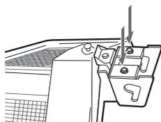
**2** 器具を金具本体に、M8 85mm、ばね座金、平座金、ナットで締め付ける。
