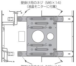
壁掛け用のネジ (M6×14) (液晶モニターに付属)
