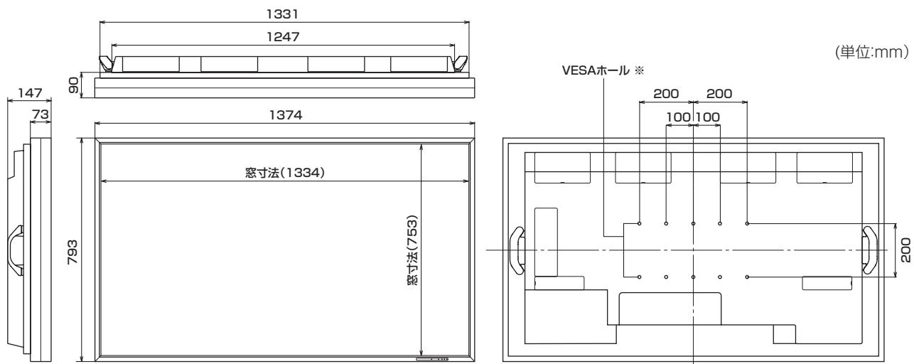
※ VESA 規格の金具の取り付けには、M6 ネジで、長さが取り付け金具の厚さ +8 ~ 10mm のものを使用してください。
