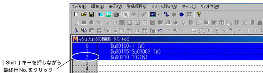
複数行がカーソルで選択されるので、[コピー]アイコンをクリックします。コピー先の先頭ラインのNo.をクリックして[貼り付け]アイコンをクリックすると、複数行が一度にコピーされます。
