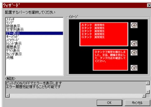
1. [ウィザード] ダイアログで「エラー表示」を選択して、「OK」をクリックします。
