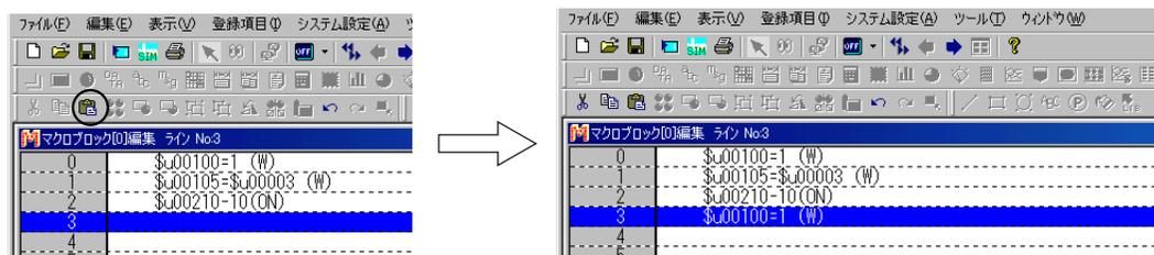
複数行を一度にコピーする場合、先頭行No.の箇所をクリックしてから [ Shift ] キーを押しながら最終行No.の箇所をクリックします。
