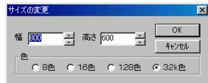
4. [幅]と[高さ]でパターンのサイズを設定します。作成できる最大のサイズは画面サイズと同じです。
