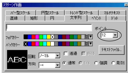
ゴシックフォントの場合、文字属性はサイズ (= [ポイント]) を設定します。Xサイズ、Yサイズともに等倍で、[ポイント]に合ったサイズに拡大・縮小されます。
