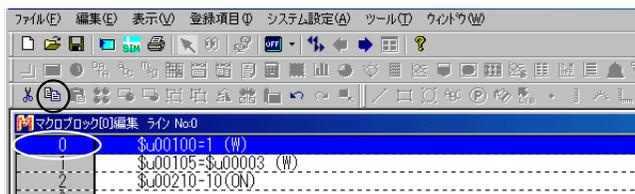
コピー先ラインのNo.の箇所をクリックし、[貼り付け]アイコンをクリックすると、コピー元の設定がコピーされます。
