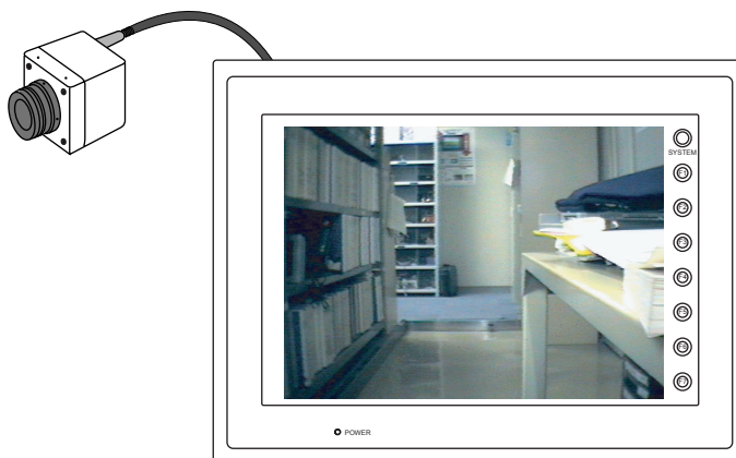
接続したビデオの映像を液晶コントロールターミナル上に表示
