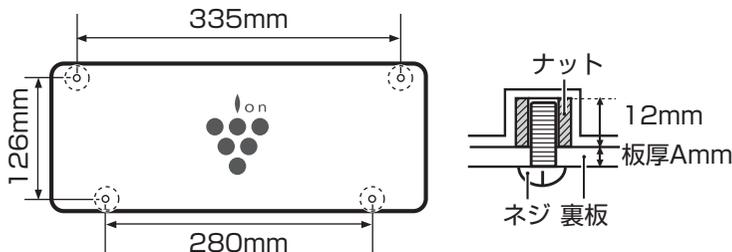
※ナットの長さは、12mmですので裏板の厚みに応じて本体が確実に固定できるネジをご準備ください。(上図参照)
