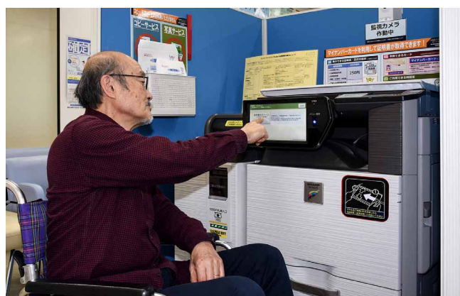
操作パネルは垂直にもでき、車椅子利用の方も使いやすい
