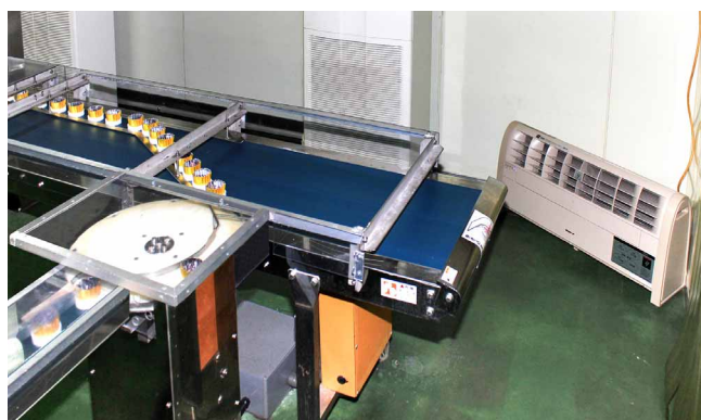
食品が空気にさらされた状態で流れる充填室。プラズマクラスターが空気浄化に貢献
