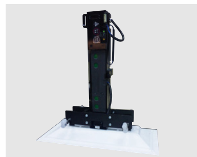
メインユニットとサブユニットがセットで、空調ダクト内に収納されている。
