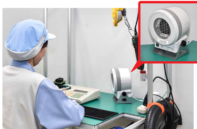
手元の作業時の除電にはコンパクトタイプを活用
