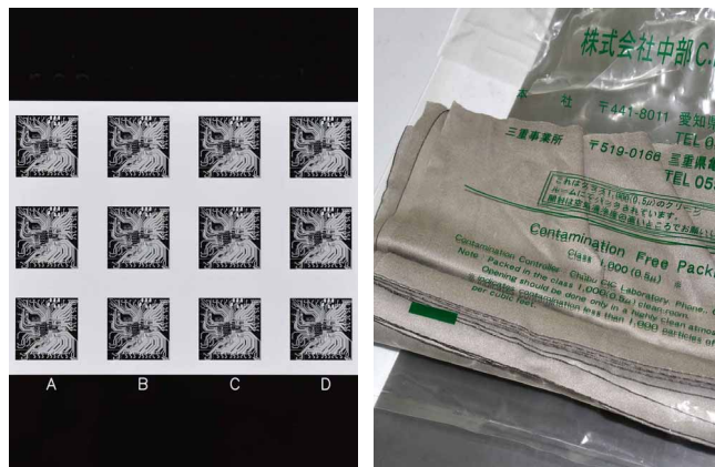
フォトマスク(左)をウエス(右)で清掃する際に強い静電気が発生する
